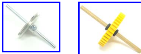
Figura 12: À esquerda eixo reto e à direita eixo quadrado.
