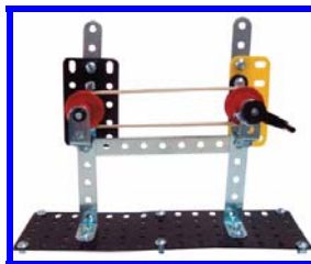
Figura 3: Polias com mesma transferência de movimento.
