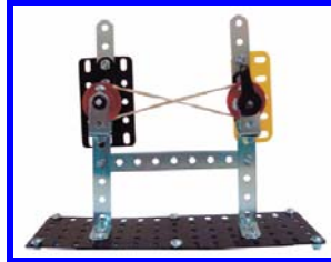
Figura 4: Exemplo de inversão de rotação.
