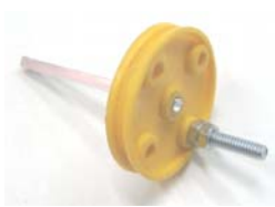
Polia de plástico sendo utilizada como manivela.
