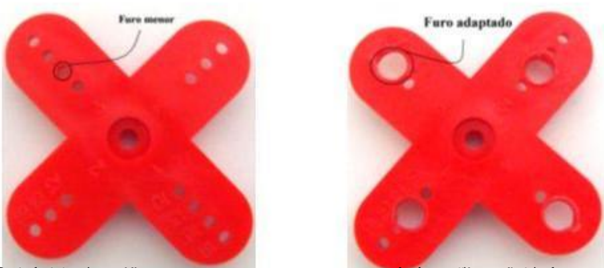
Figura 2: Adaptação de um furo para o servo motor. Após a adaptação do furo com um fio de cobre, o servo motor pode ser utilizado.
