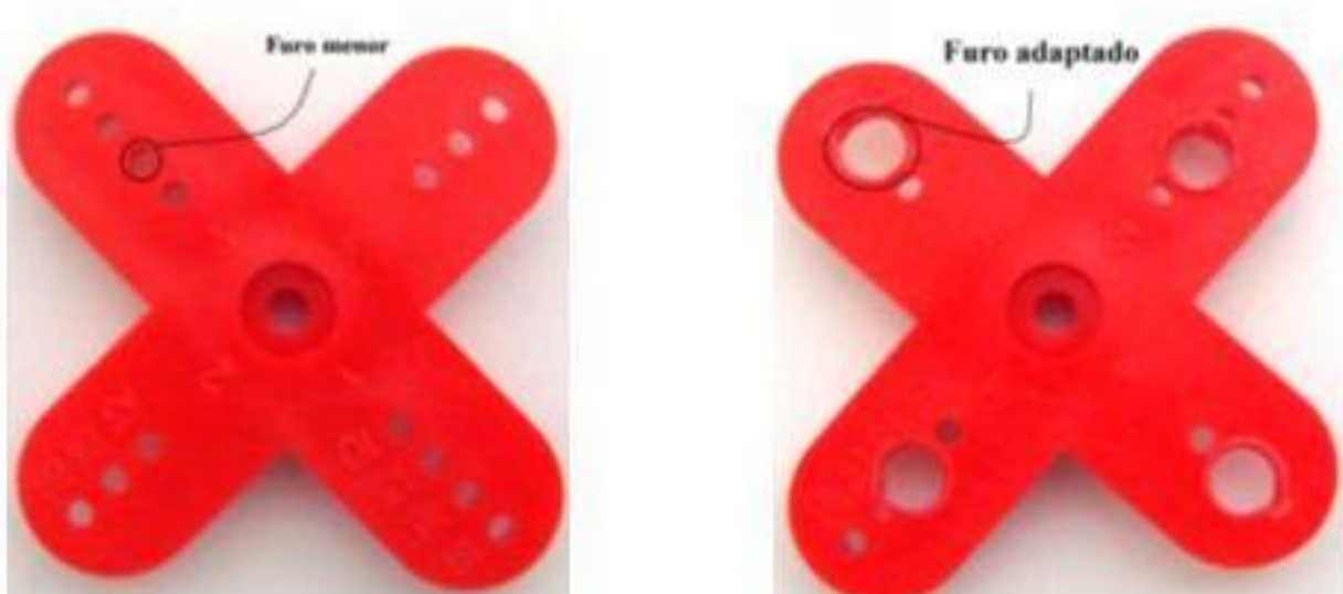
Figura 2. Montagem do servo motor com o controle remoto e o receptor de rádio. Após a adaptação do furo com o fio de cobre.
